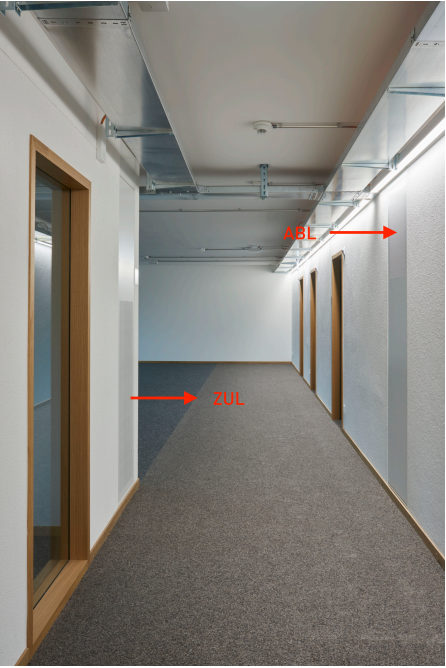
Zu- und Abluft (ohne Kurzschluss!)
